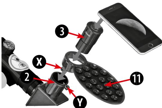
Вставьте окуляр (3) в держатель смартфона (11) и вкрутите винт (Х) в крепежную планку. Установите держатель смартфона с окуляром в окулярное соединение (2) и рукой затяните зажимные винты (Y).
